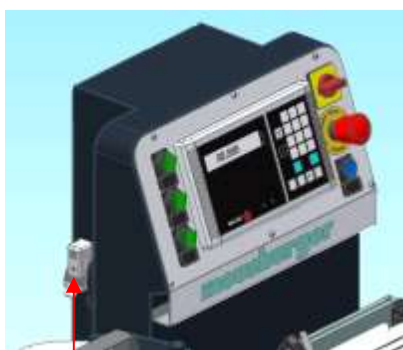
Obudowa przystawki 3A 230V/16A 50Hz pompy układu
