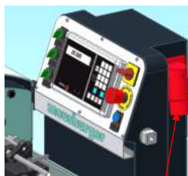
Wtyczka Cekon 400V/16A 50Hz ze zmiennikiem faz
