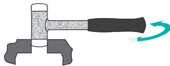
Bloccare saldamente il battente usurato nella morsa, e allentarlo ruotandolo lateralmente.
